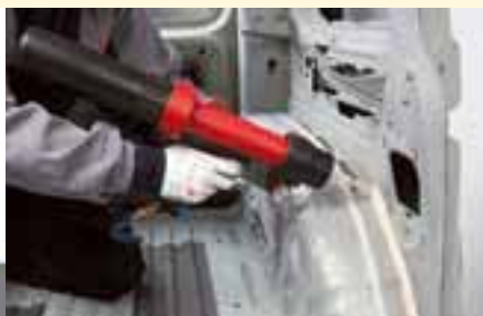
»4 Terostat ermöglicht eine echte Flatstream-Abdichtung nach der Reparatur
